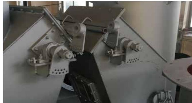
Предохранительный клапан с защитой от засорения
