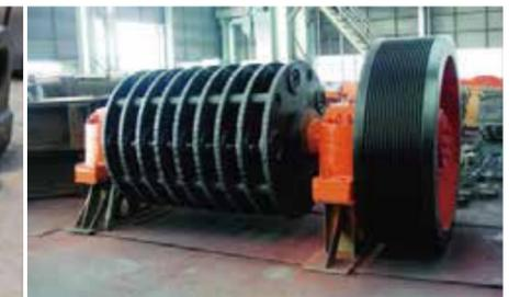
Узел ротора дробилки
