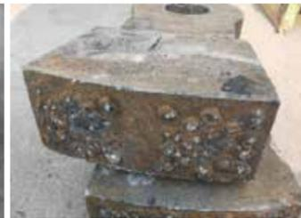
Молоток со вставным сплавом
